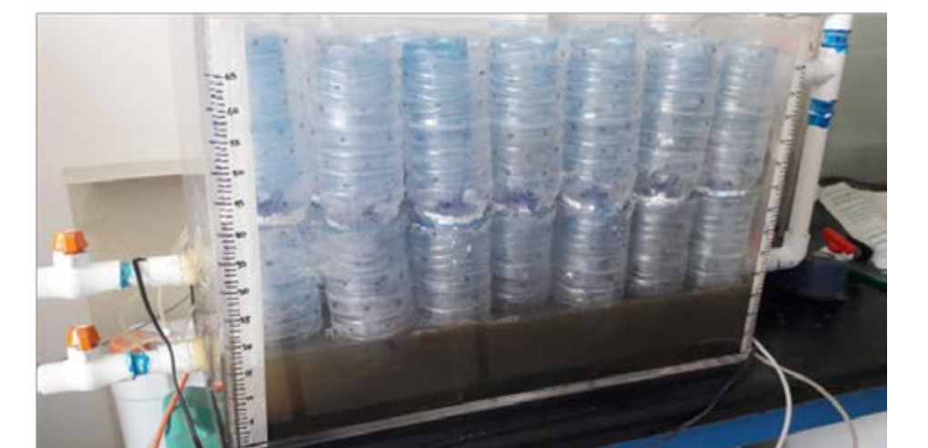
Figura 1. Reactor Biológico anaerobio con las botellas de PET ordenadas e inoculación de los lodos.
