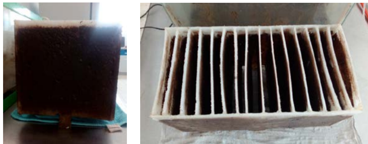
Figura 5. Adherencia del lodo al medio de soporte PEAD.
