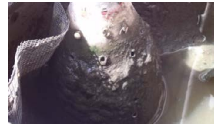
Figura 4. Biomasa adherida a las paredes de las botellas de PET.
